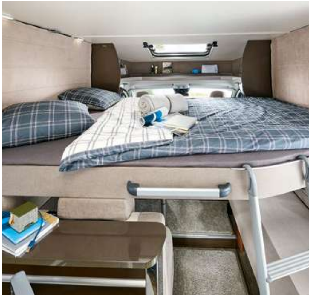
Het hefbed gaat rechtstandig omlaag en omhoog. De deur blijft vrij als het bed naar beneden is. Een stevig mechanisme houdt het bed tijdens de rit veilig op zijn plek en is in iedere stand te fixeren.
